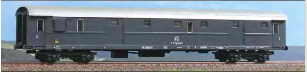
Bagagliaio FS Tipo 1946 (Dz 93000) in livrea grigio ardesia, carrelli FS 27. Type 1946 luggage car (Dz 93000) of the FS, slate gray livery, Type FS 27 bogies. Typ 1946 Gepäckwagen der FS (DUz 93000), schiefergrauer Lackierung, Typ FS 27 Drehgestelle
