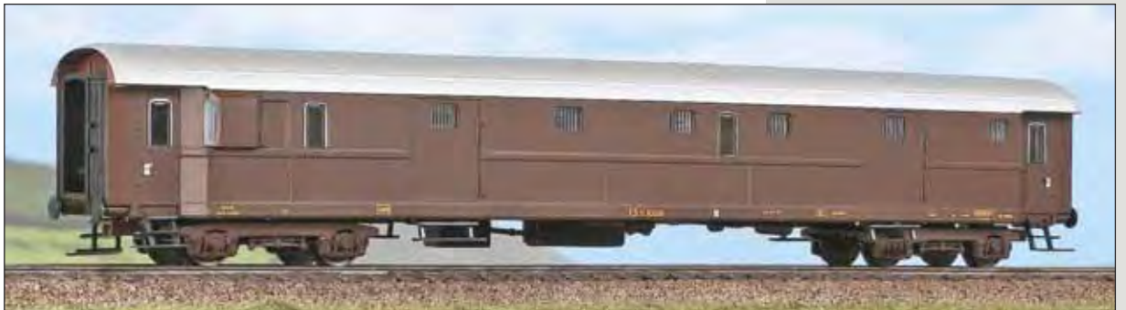
Bagagliaio FS Tipo 1946 (Dz 83000) in livrea castano, carrelli FS 27. Type 1946 luggage car (Dz 83000) of the FS, brown livery, Type FS 27 bogies. Typ 1946 Gepäckwagen der FS (DUz 83000), braune Lackierung, Typ FS 27 Drehgestelle
