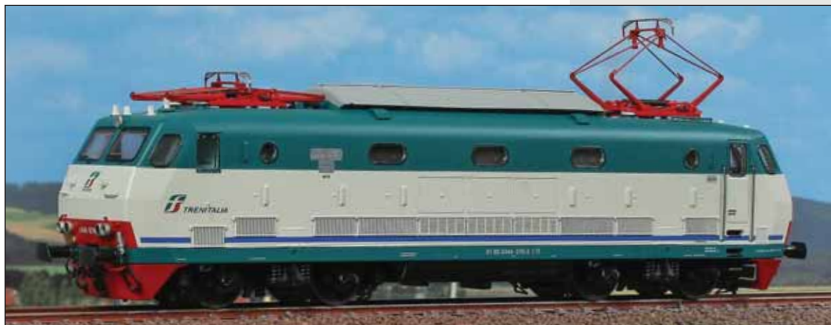
Locomotiva elettrica FS E.444R stato attuale, con conduttori a 13 poli per il comando lateralizzato delle porte del treno. Electric Locomotive FS E.444R in today's conditions, with 13-pin cable for independent side control of the train doors. E-Lok E.444R der FS in derzeitiger Version, mit 13-Pol-Kabel für die seitenabhängige Steuerung der Zugtüren
