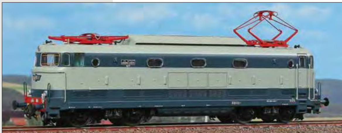
Locomotiva elettrica E.444.004 dopo la ricostruzione del 1986, modificata con i vetri frontali delle unità di serie. Electric Locomotive E.444.004 after rebuilding of 1986, modified with front windows of standard units. Elektrolokomotive E.444.004 nach der Umbau von 1986, mit den Frontscheiben der Serienloks verändert.
